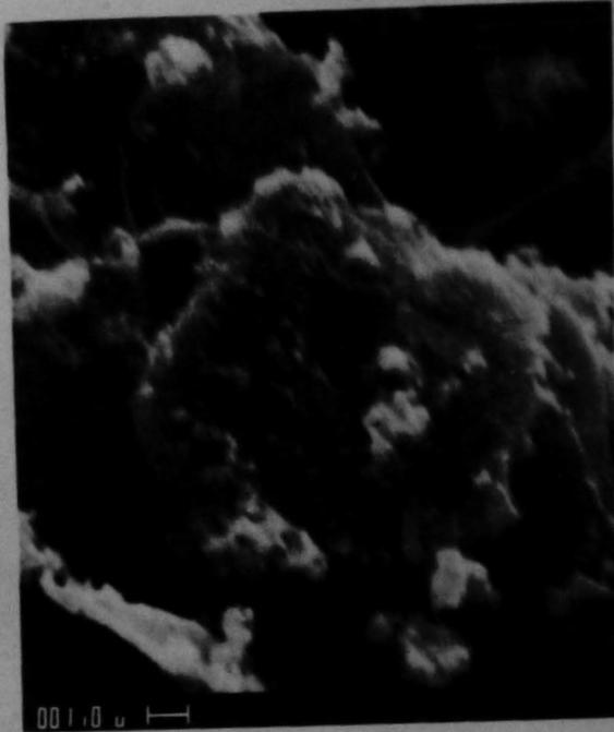
HIGH ZIRCONIUM PARTICLE
